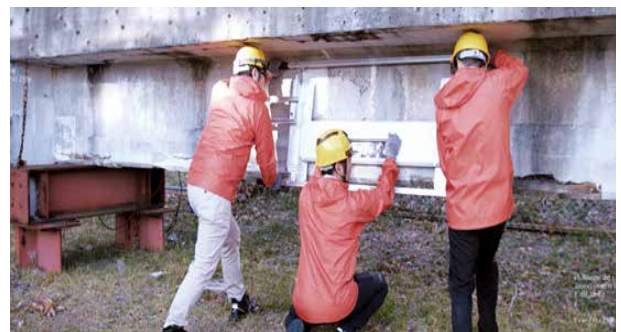
橋梁の内部鋼材破断を可視化する非破壊検査の様子
